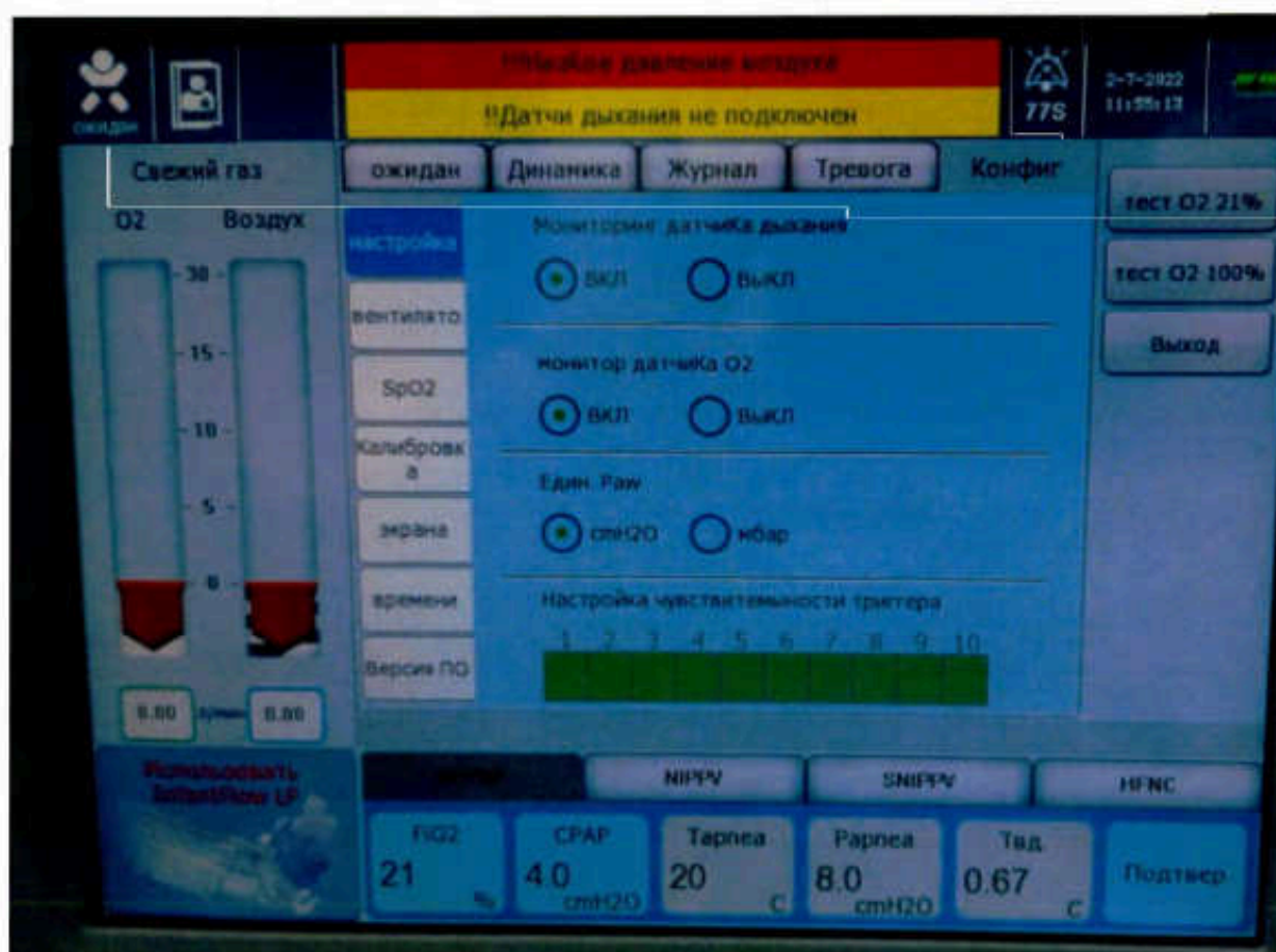
Рис. 3.14.1 Настройка единиц измерения давления
