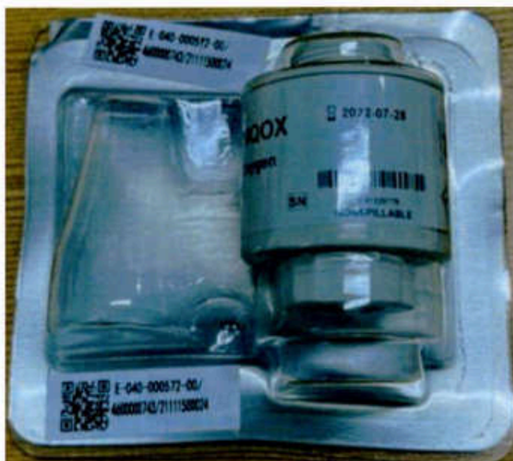
Рис. 2.2.59. Датчик кислорода, модель INQOX, производитель EnviteC-Wismar GmbH
