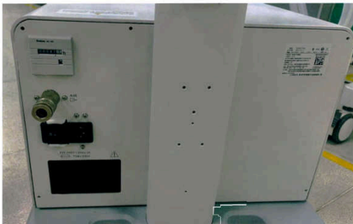
Рис. 2.2.46. Компрессор воздуха VS-20 вид сзади
