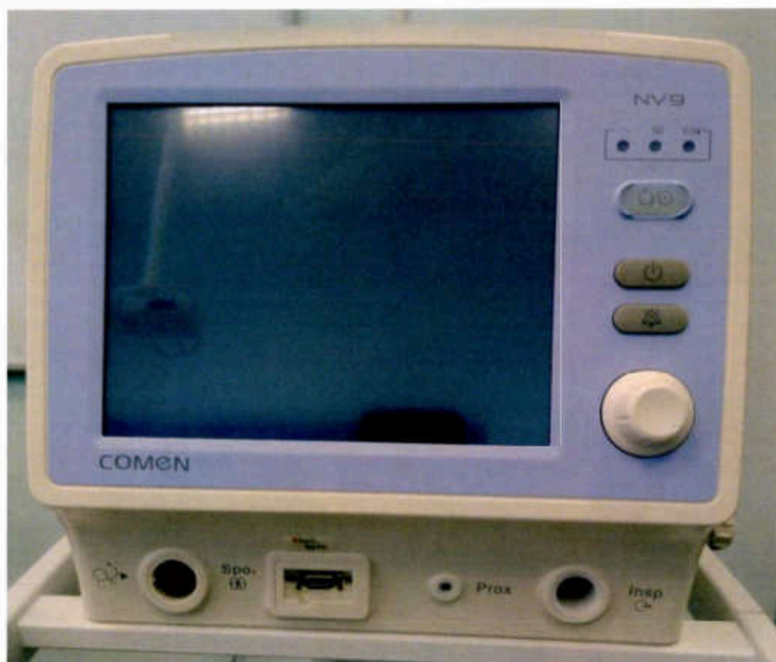
Рис. 2.2.41. Блок основной NV9 вид спереди
