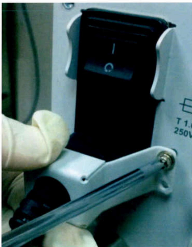
Рис. 5.1.15. Закрепление кабеля питания
