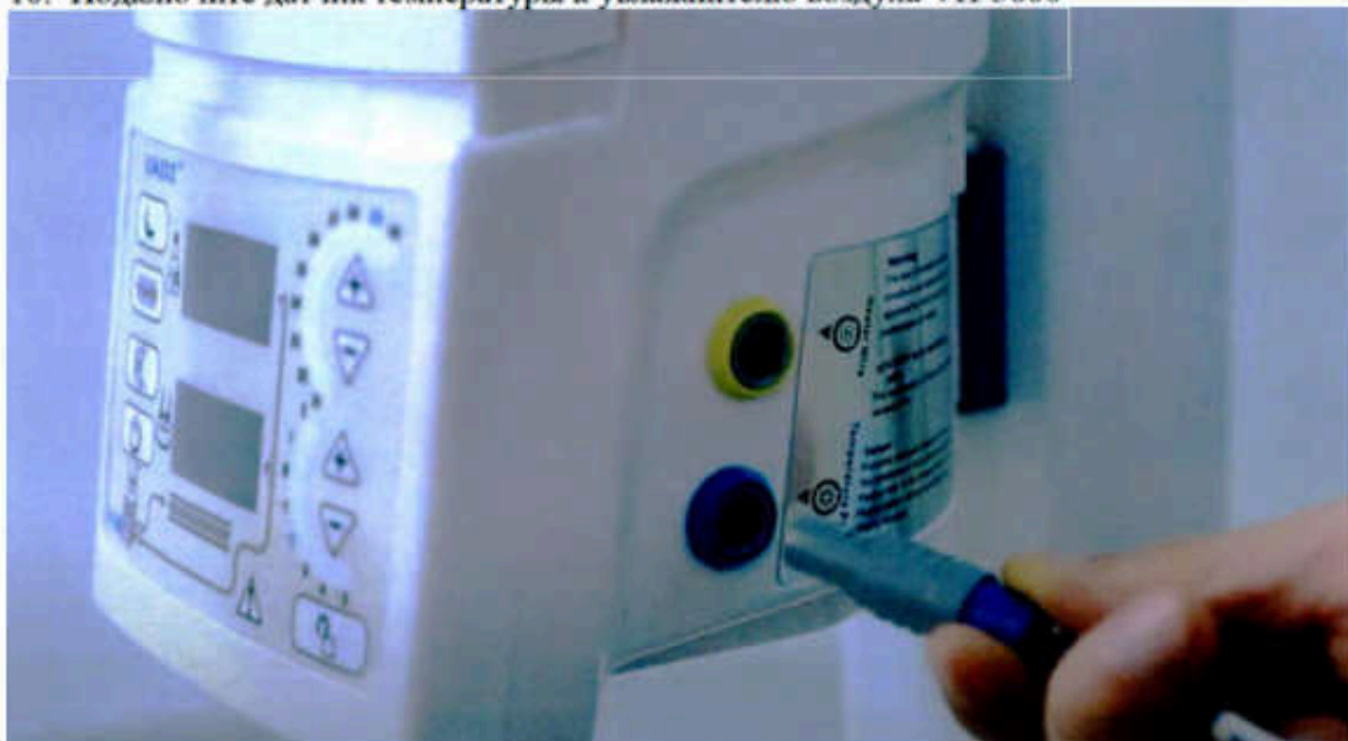
Рис. 5.1.35. Подключение датчика температуры к увлажнителю воздуха VH-3000
