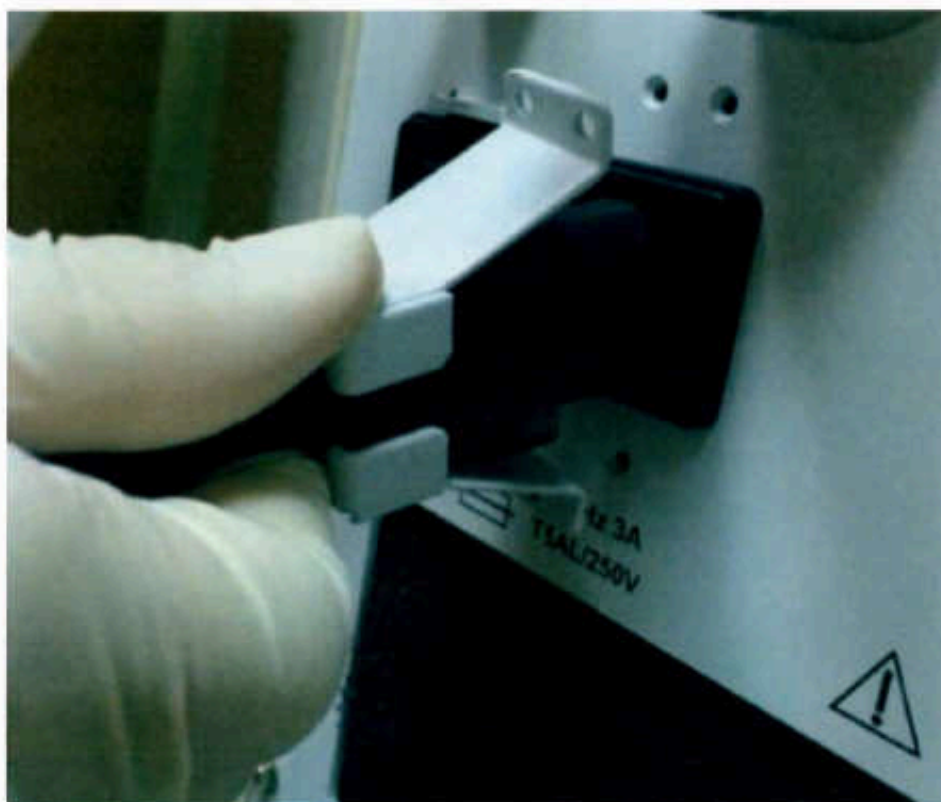
Рис. 5.1.18. Подключение кабеля питания к компрессору воздуха VS-20
