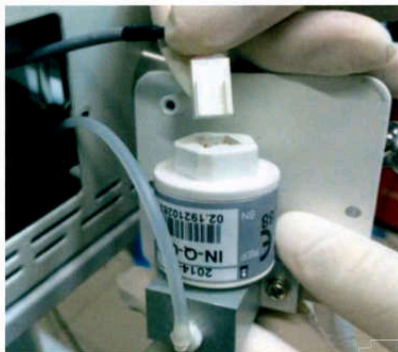
Рис. 11.6.3. Отсоединения провода блока основного от датчика кислорода
