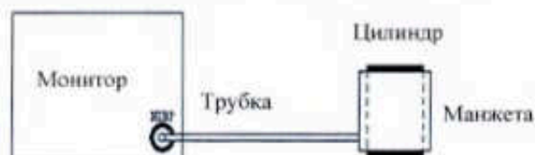
Рис. 28-1. Схема подключения для тестирования утечки газов в контуре НИАД
