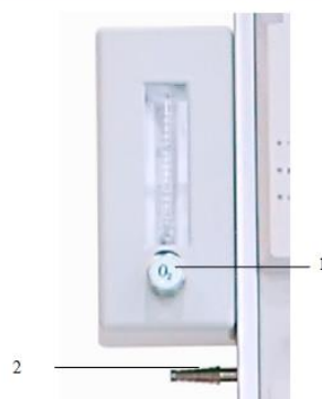
Рис. 12 Расходомер вспомогательной подачи O 2 и его управление
